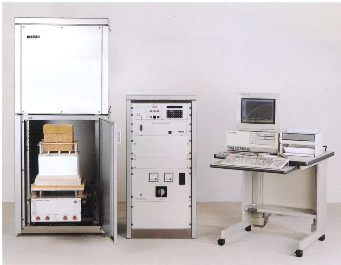
Прибор для определения теплопроводности ТСТ 426 с контроллером и компьютером (измерительная часть открыта с опущенной измерительной ячейкой)
